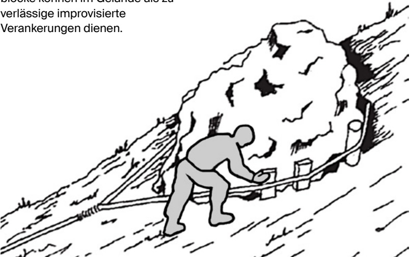
Abb.16: Verankerung an einem Felsblock (Schweizer Armee)
