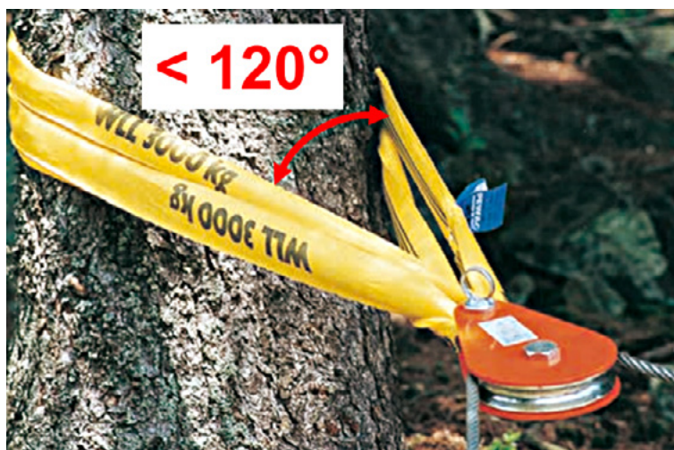
Abb. 23: Zulässiger Spreizwinkel von Verbindungsmitteln oder -elementen
