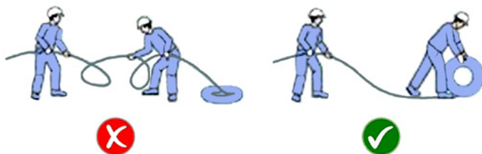
Abb. 28: Richtiges Abrollen von Drahtseilen (Kloska Group)
