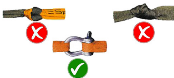
Abb.25: Rundschnüren und Hebebänder dürfen nie geknotet, sondern müssen immer mithilfe von Schäkeln oder Lasthaken verbunden werden (Kloska Group)
