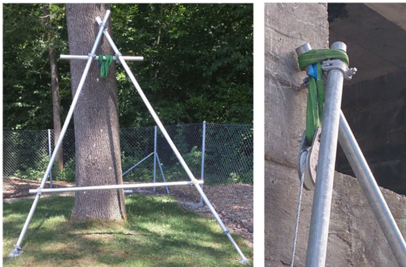
Abb. 52: Beispiele von Zweibeinen aus Gerüstrohren
