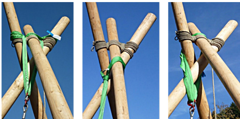
Abb. 48: Mögliche Anschlagarten von Rundschlingen am Dreibein
