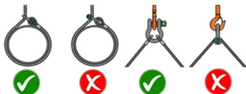
Abb.27: Richtige Anwendung von Schäkeln (Kloska Group)
