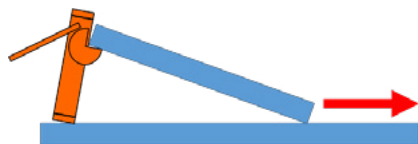
Abb. 61: Horizontale Kraft bei angewinkeltem Hebege­rät
